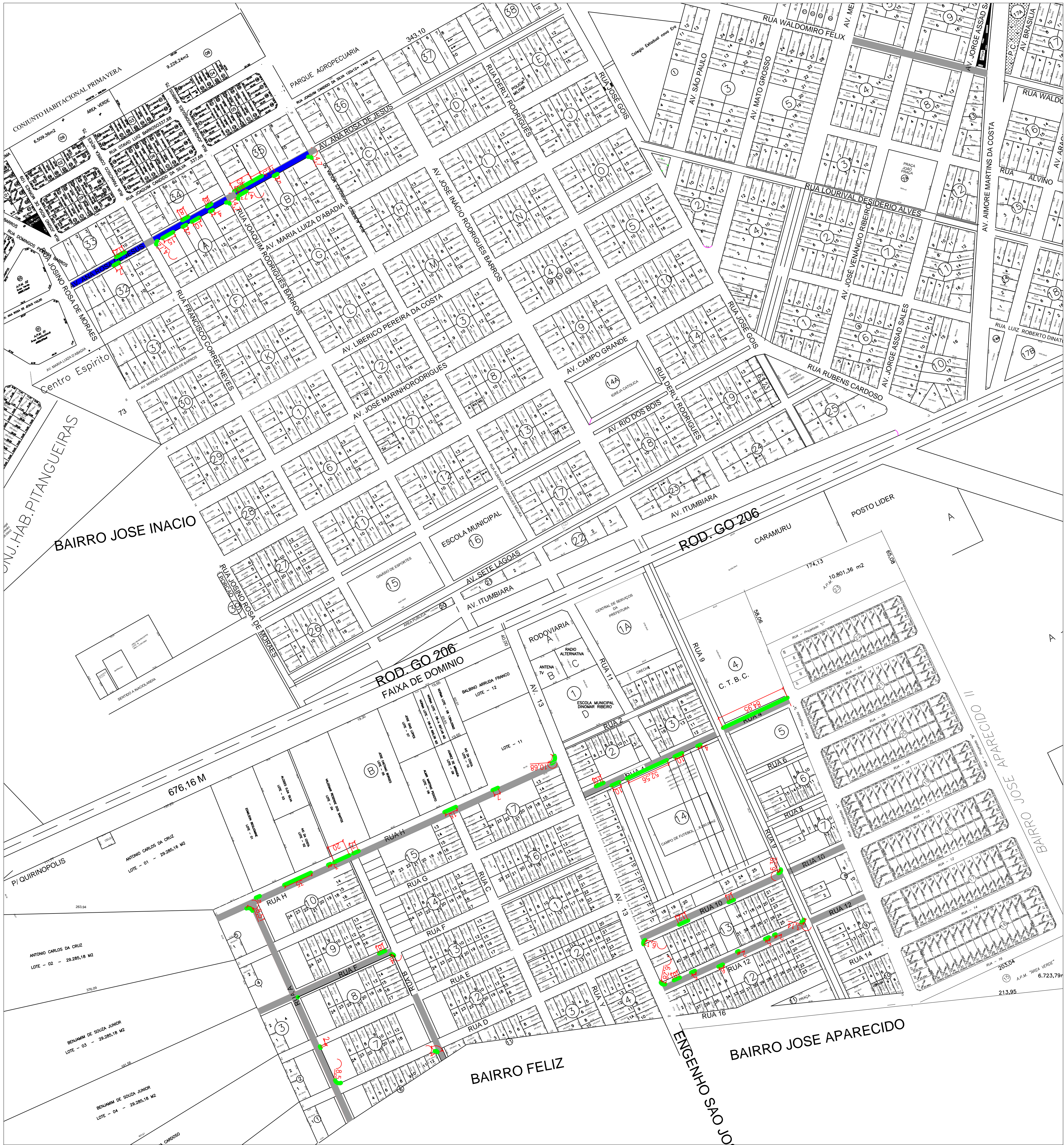
PLANTA ILUMINADA - RECAPEAMENTO INACIOLÂNDIA - MEIO FIO ESCALA 1/2500 LEGENDA: ÁREA RECAPEADA - BM 01 ÁREA A SER RECAPEADA MEIO FIO A SER RECUPERADO
