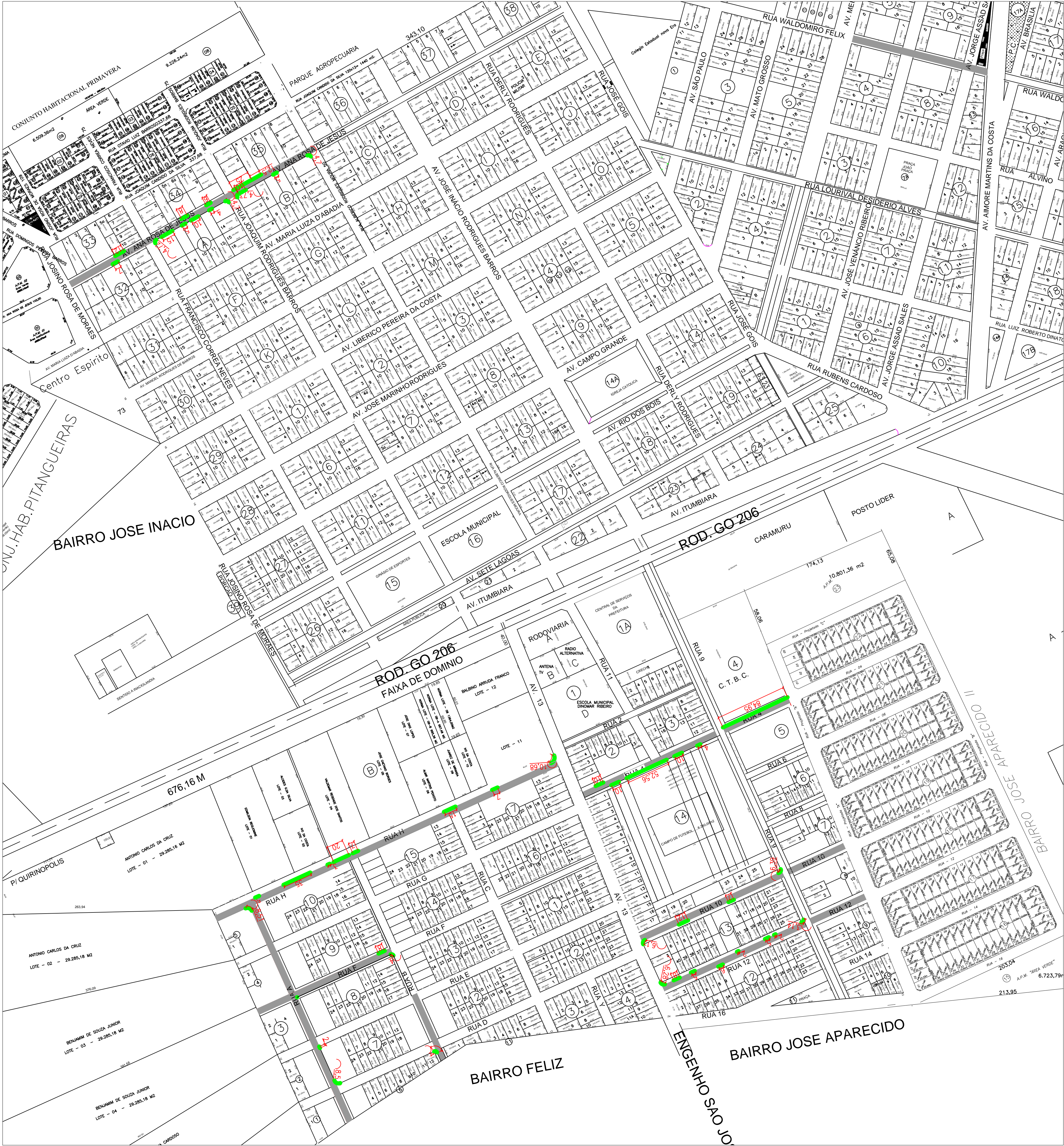
PLANTA ILUMINADA - RECAPEAMENTO INACIOLÂNDIA - MEIO FIO ESCALA 1/2500 LEGENDA: ÁREA A SER RECAPEADA MEIO FIO A SER RECUPERADO
